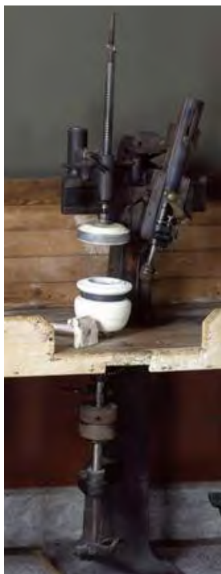
Centreuse : formation du creux par estampage dans un moule en plâtre
