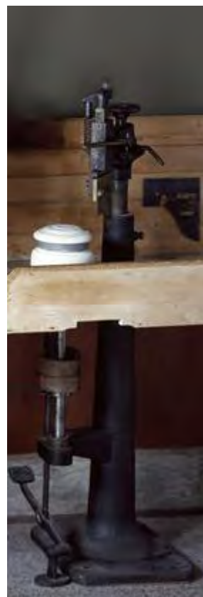
Calibreuse : passage d'un gabarit qui ôte le surplus de pâte et donne les dimensions et la forme à l'assiette
