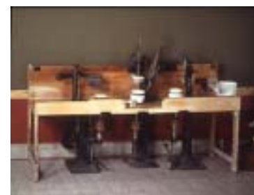
Photo 4 : Machine Faure, ADL 9958 (salle des techniques). La machine Faure permet la réalisation d'une assiette en trois étapes : aplatissage de la galette de pâte, formation du creux par estampage, puis du revers par le passage d'un gabarit qui ôte le surplus de pâte.
